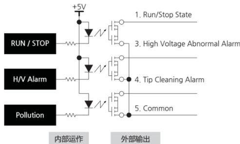
输入回路图(DC 24V 输入)
