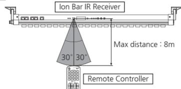
遥控器讯号的收讯范围是左右 30°、直线距离 8m 以内的. 如遥控器不能启动的话, 先确认遥控器与离子棒之间是否存在障碍物, 然后再确认遥控器的电池状态.
