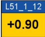
정전압 측정 센서 아이콘에서 ID와 현재의 측정값이 나타납니다. 설정에 따라 배경에 흐리게 6초 동안의 측정값 그래프를 표시합니다.
