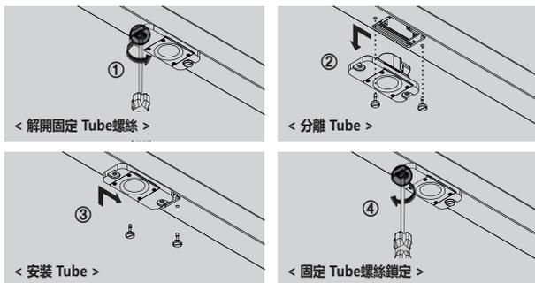
※ Tube交替之後在 Controller實行 Tube Reset。(參考 SXC-10BT/BL動作手冊)
