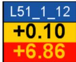
静電気測定値が測定領域を超えると、直近の超過値が点滅しながら、最下段に表示されます。
