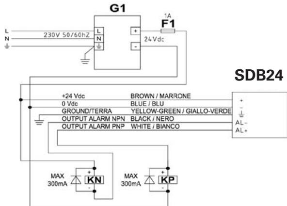
위 다이어그램과 같이, 경류전압을 제품에 연결합니다. 0V (터미널1), 24V(터미널 2) 그리고 접지(터미널4). 24Vdc 파워 서플라이를 제품에 연결하기 위해 그라운드 와이어를 연결해야 합니다. (Female 커넥터의 핀4)
