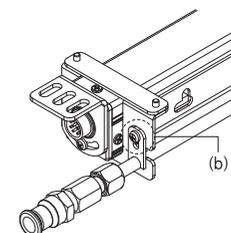
Air Pipe の揺れがある時上記の部品を下に最大限密着させ固定ボルトを改め締めてください。(b)
