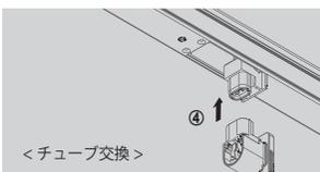
\* Tubeを交換した後、ControllerでTube Resetを実行してください。
