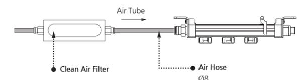
\* 使用環境に応じ、適したエアフィルターを使用してください。「クリーン環境ではクリーンエアフィルター(透過度 0.01µm)の使用を推奨します。」
