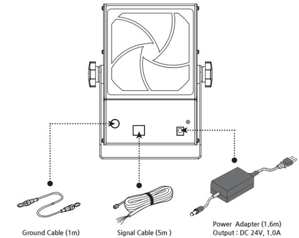
※ 装置の性能維持および感電事故予防のため装置本体は必ず接地してください。Signal Cableは外部でSBL-15Sを制御や動作状態の確認する時に使います。パワーアダプタの入力電源は AC 100~240V, 50/60Hzです。
