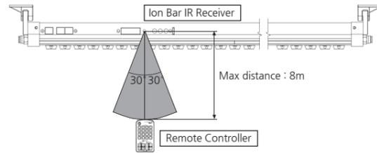
遥控器讯号的收讯范围是左右 30°、直线距离 8m 以内的。如遥控器不能启动的话、先确认遥控器与离子棒之间是否存在障碍物、然后再确认遥控器的电池状态。
